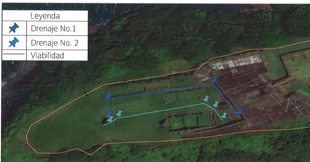
Ilustración 8. Sistema de drenaje pluvial del Patio de Armas.
