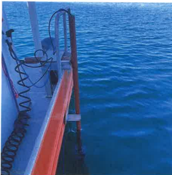
Transductor MB, IMU y SVP sumergidos.
