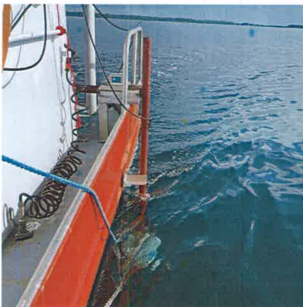
Pole SBP con transductor sumergido
