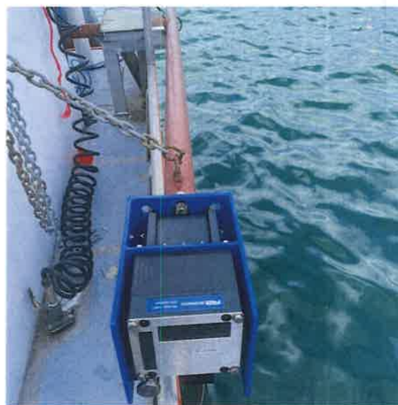
Transductor MB, IMU y SVP instalados.
