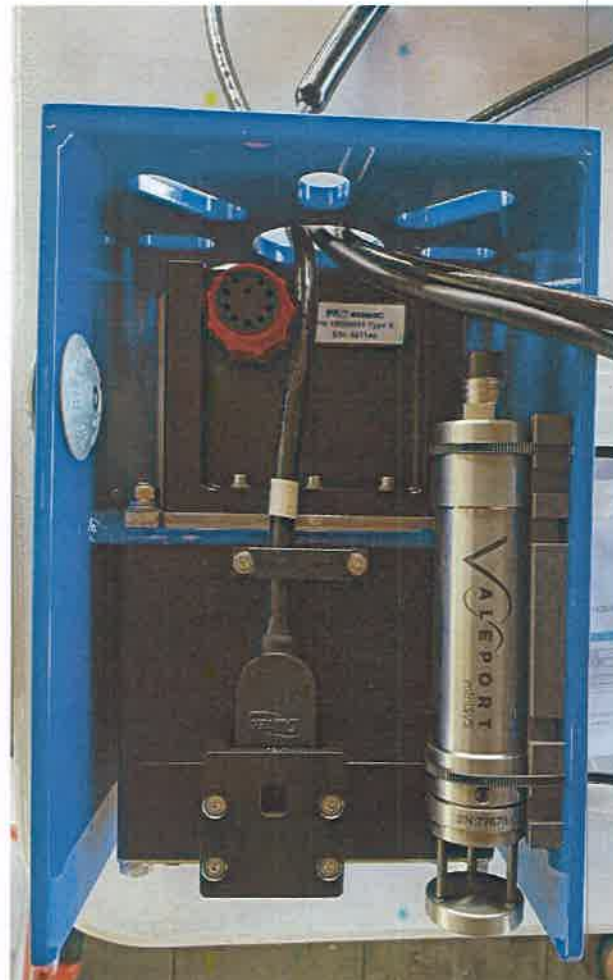
Arreglo IMU, MB y SVP en bracket.
