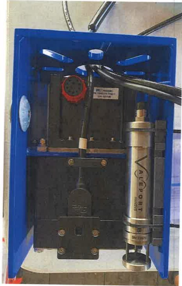
Arreglo IMU, MB y SVP en bracket.
