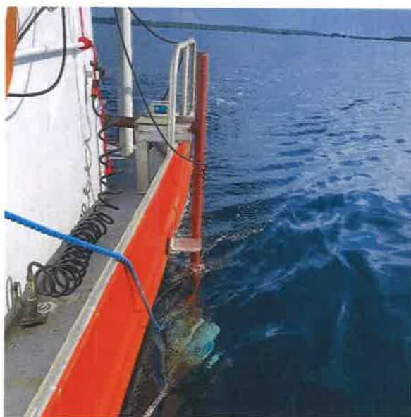
Pole SBP con transductor sumergido
