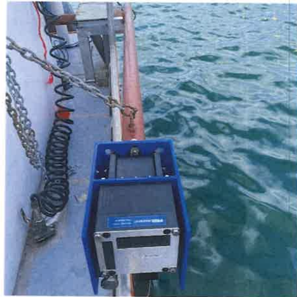
Transductor MB, IMU y SVP instalados.
