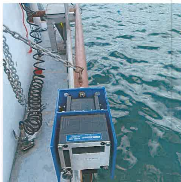
Transductor MB, IMU y SVP instalados.
