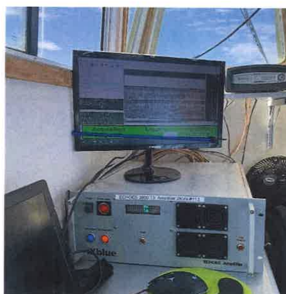
Top Unit SBP, GNSS y computador de sondeo
