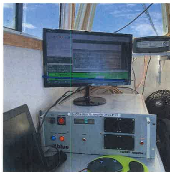
Top Unit SBP, GNSS y computador de sondeo
