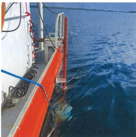
Pole SBP con transductor sumergido
