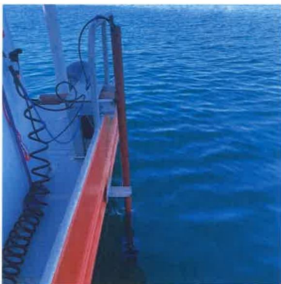
Transductor MB, IMU y SVP sumergidos.
