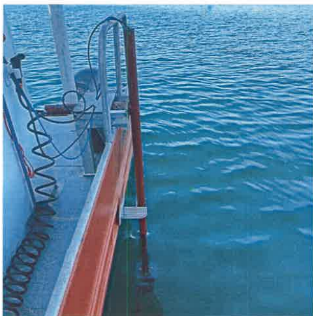
Transductor MB, IMU y SVP sumergidos.
