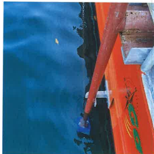
Transductor MB, IMU y SVP sumergidos.
