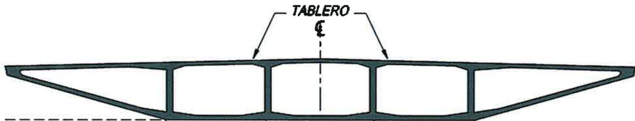
Figura N° 3.6. Opciones de tablero para tramo central de vano principal. Fuente: TYLin International.
