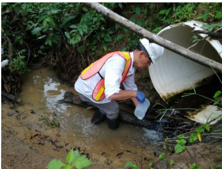
Foto 13. Aforo simple de llenado un volumen conocido en el tiempo. Fuente hídrica o drenaje superficial, nótese la alcantarilla y el pequeño flujo o caudal.
