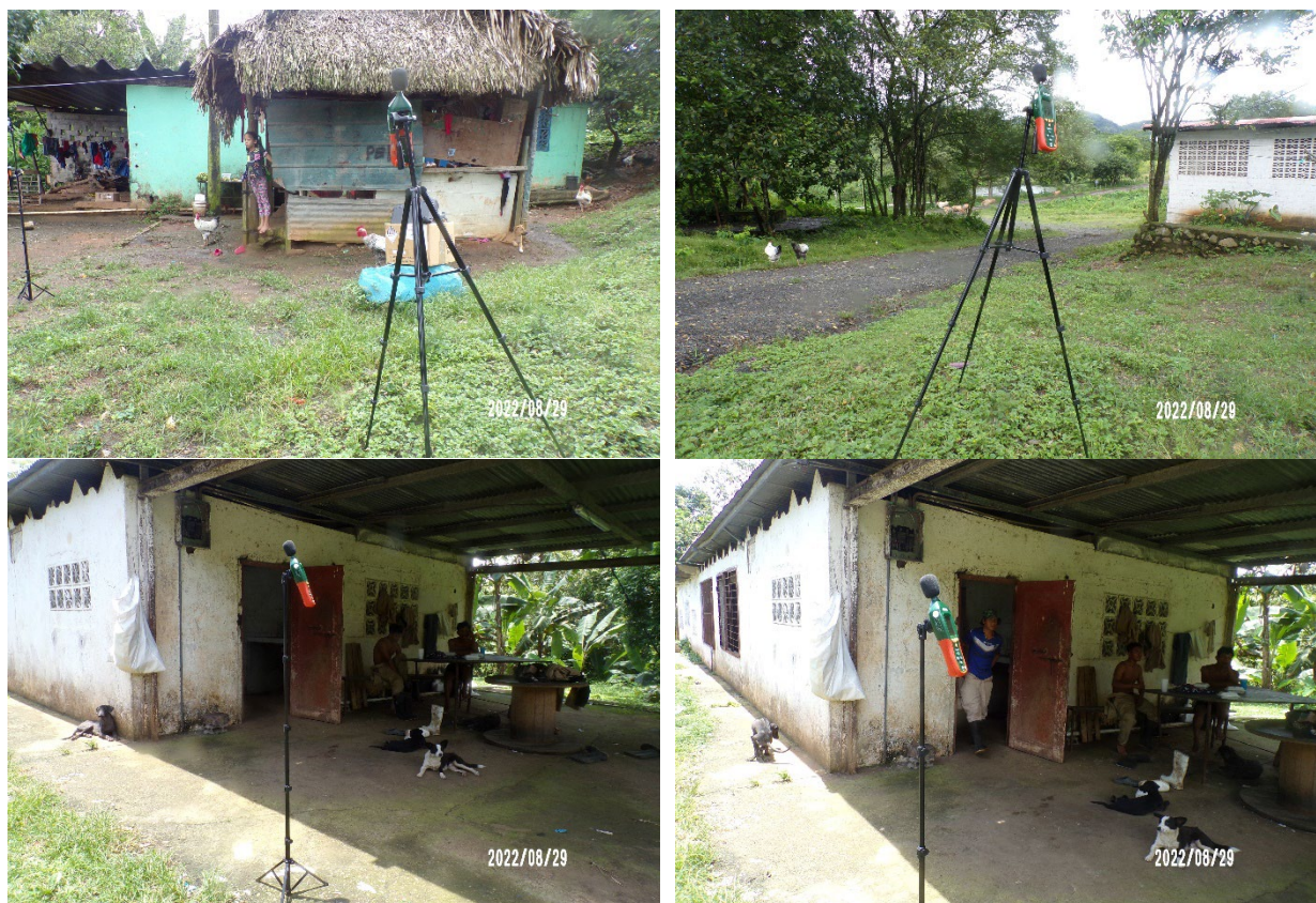
Figura N°12. Mediciones de ruido ambiental
