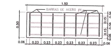
PLANTA ESTRUCT. BANCA DE CONCRETO ESCALA = 1 : 20 CONCRETO F'C= 200 KG/CM2
