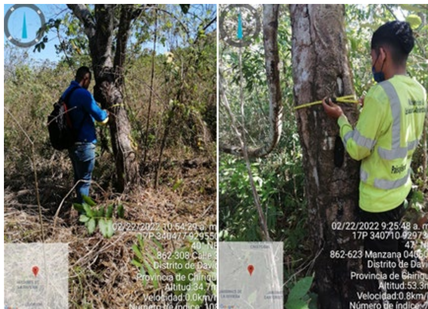
Figura No. 1. Corrección de la Figura No. 17. Medición de la circunferencia en centímetros de las especies forestales, base para el cálculo del DAP. Fuente: D. Aponte, 2022.
