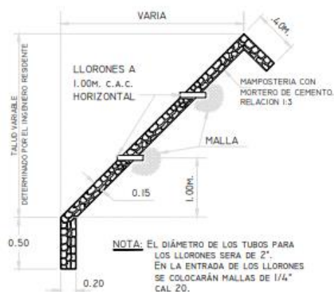
Imagen #5. Sección Típica de Zampeado.
