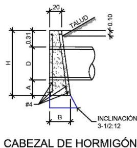
Imagen # 6. Detalle de Cabezal de Hormigón
