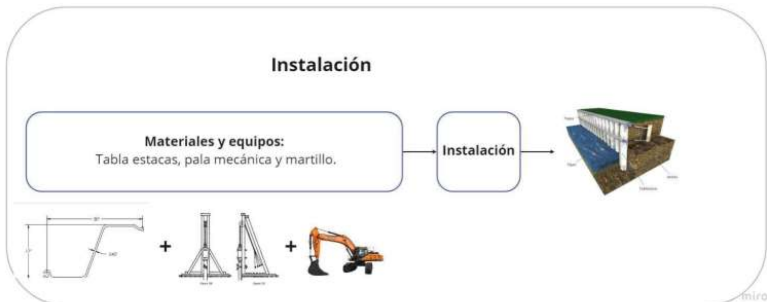
Imagen No.9: Proceso de instalación de tabla estacas. (Fuente: Confección CET MANAGEMENT INC).
