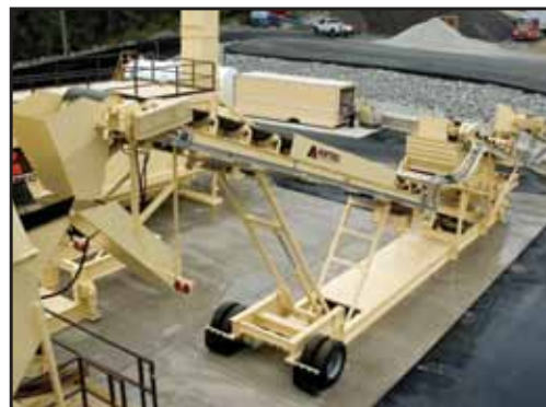
Una sola carga incluye el transportador de transferencia, la criba de malla ancha, la zaranda y el puente de pesaje.
