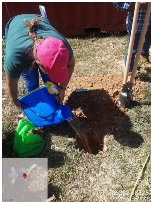
Vista. Perforación del hueco y saturación del suelo.
