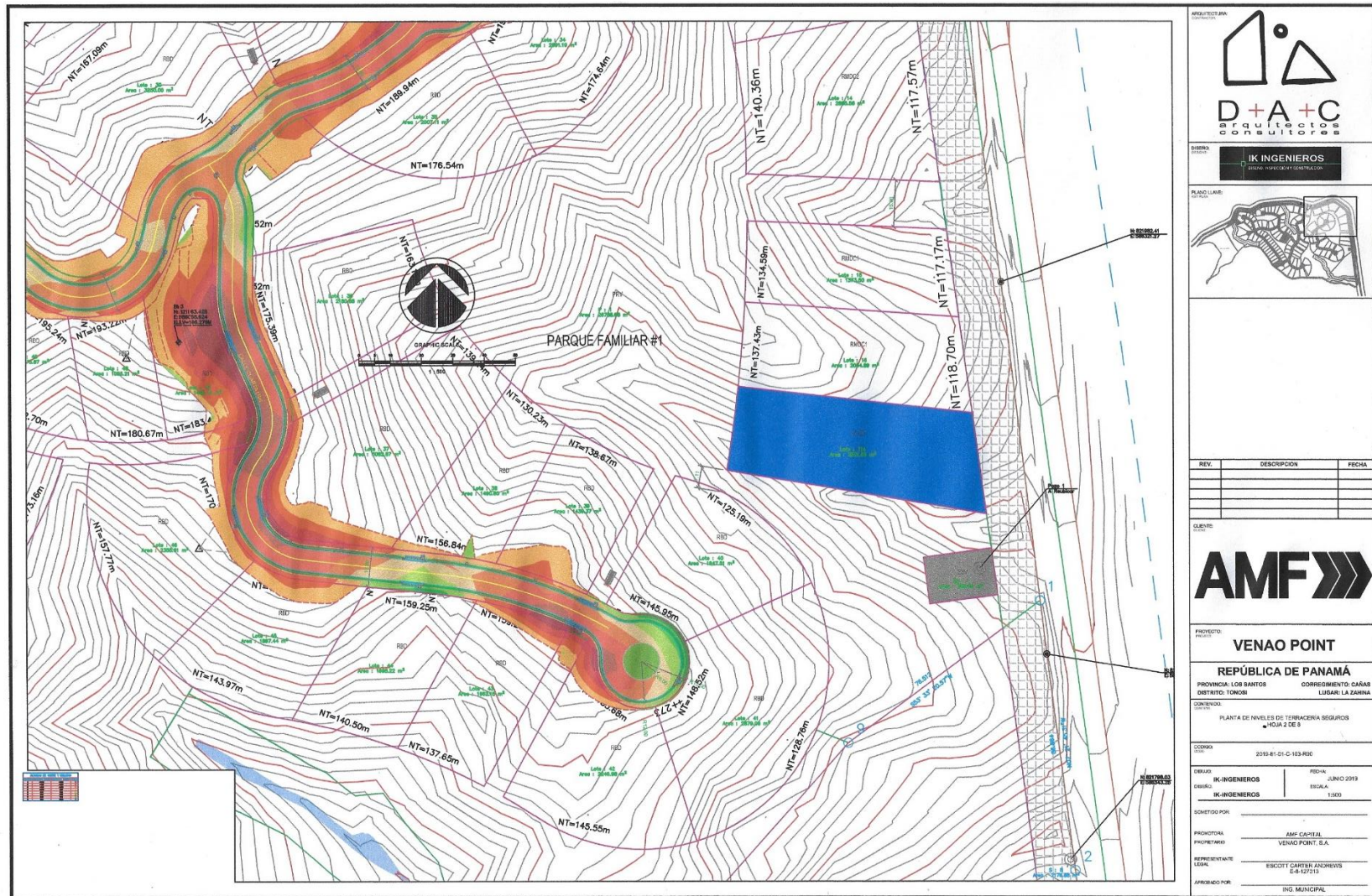
Plano N°8: Planta de Corte y Relleno solo para (Calles y Servidumbre Vial) ( Vista de Calle Cuarta)
