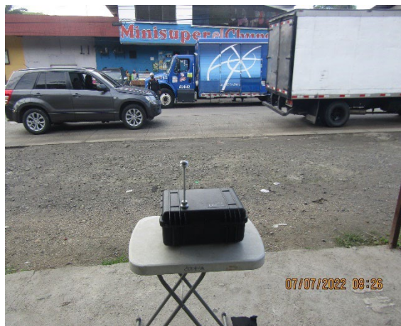
Imágenes 1 y 2. Vistas del equipo durante la medición de PM_{10} en el Punto 1
