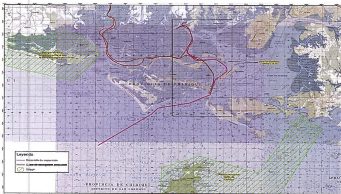
Imagen 8. Recorrido de navegación propuesto por el promotor, mapa que demuestra que la batimetría de la zona es inferior a 10 m de profundidad.
