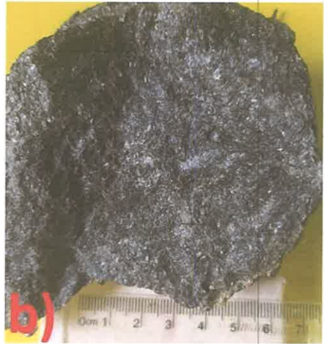
Figura 9. GABRO: (a) forma de ocurrencia en campo; bloque sub-redondeado de aproximadamente 50 cm de diámetro (b) detalle de la textura fanerítica, compuesta por piroxenos, plagioclasas y magnetita.
