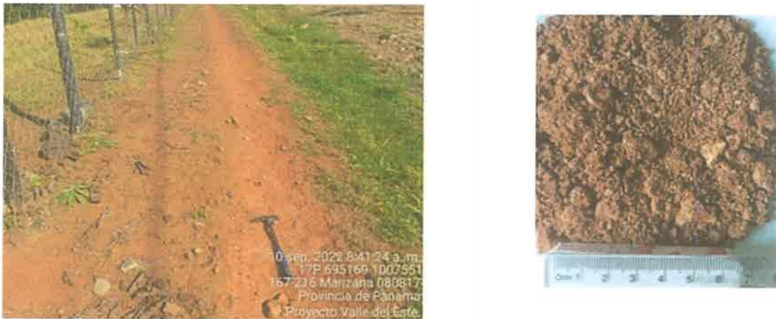
Figura 7. SAPROLITA: Marrón anaranjado, arcillosa con textura original obliterated. Foto de la derecha, detalle de la textura terrosa con remanentes de la textura original.
