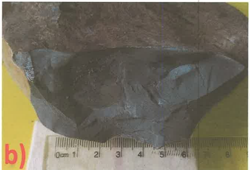
Figura 10. CALIZA: a superficie meteorizada de la roca; b detalle en superficie fresca, donde se observa la textura fina de la roca
