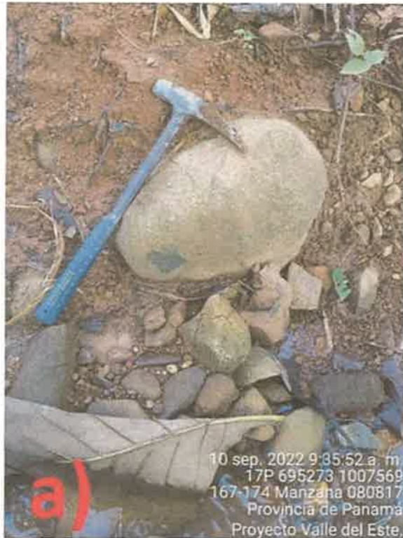
Figura 9. GABRO: (a) forma de ocurrencia en campo; bloque sub-redondeado de aproximadamente 50 cm de diámetro (b) detalle de la textura fanerítica, compuesta por piroxenos, plagioclasas y magnetita.
