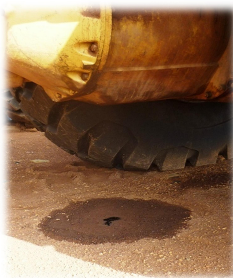
Fotografía 77 Evitar el goteo de lubricantes directamente sobre el suelo
