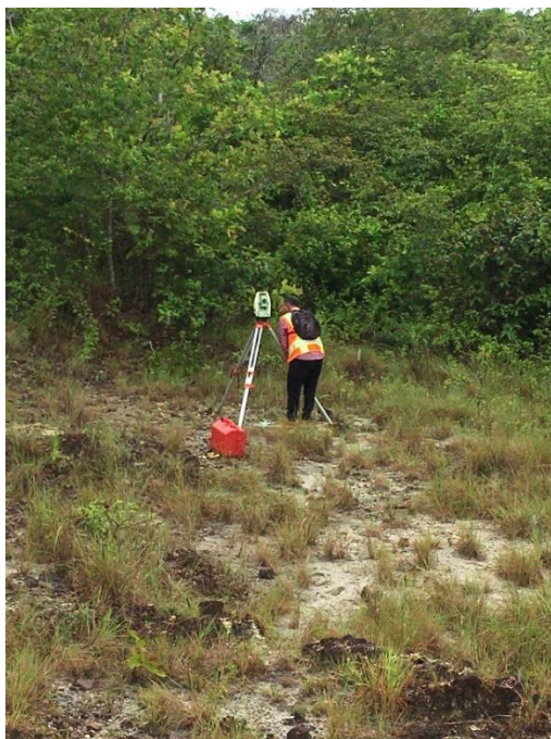
Figura A.2.4 Foto de equipo utilizado para levantar la topografía de la quebrada Hernández.
