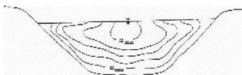
Figura 3. Distribuciones típicas de la velocidad en un canal abierto.
