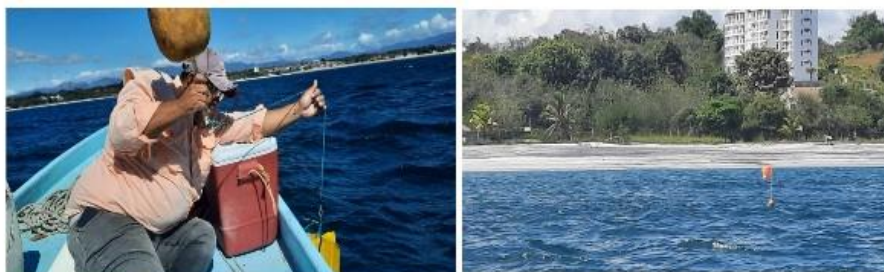
Foto 2 y 3. Colocación de derivadores para medir la corriente sitio, Turicentró San Carlos Panamá Oeste.
