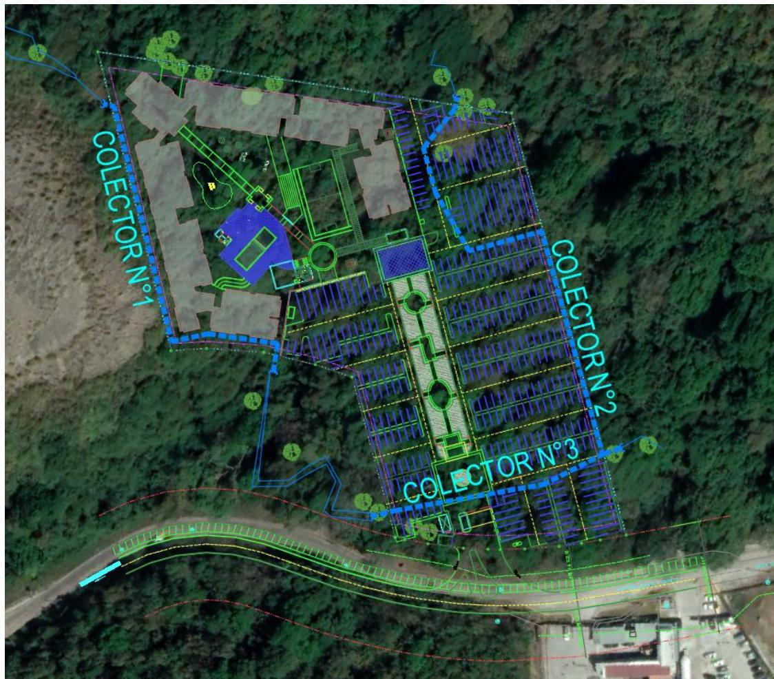
Ilustración 5: Colectores de Infraestructura Pluvial
