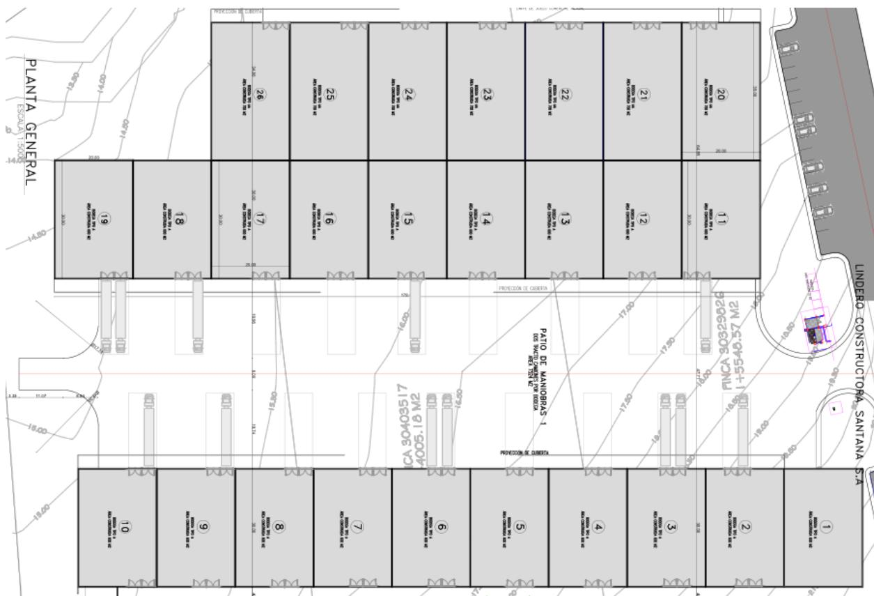
Figura 6. Planta de las 19 bodegas Tipo A de 600 m2 c/u; 7 bodegas Tipo AA de 700 m2 c/u
