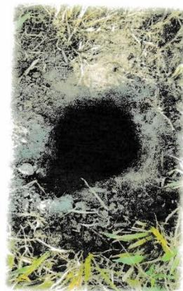
Foto 2: Excavación del hoyo durante la prueba de percolación. Marzo 2,023.
