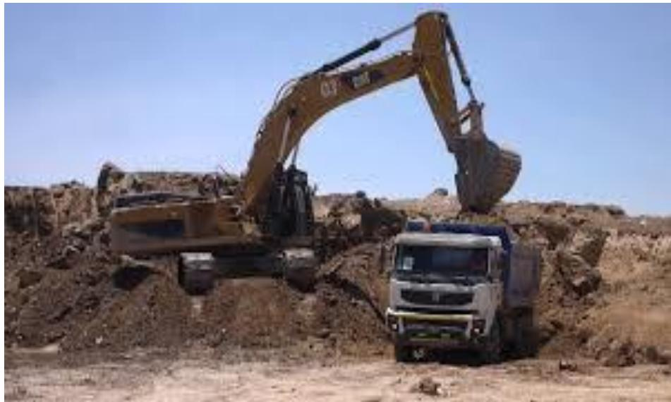
Los camiones volquete trasladarán la roca directamente hasta la trituradora primaria donde se iniciará la producción de los agregados. Estos camiones son especiales para el traslado de rocas, por lo que cuentan con vagones reforzados, así como llantas y accesorios para uso en condiciones especiales de trabajo minero.
