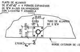
DETALLE TIPICO DE ANCLAJE DE BARANDA ESC. 1:15
