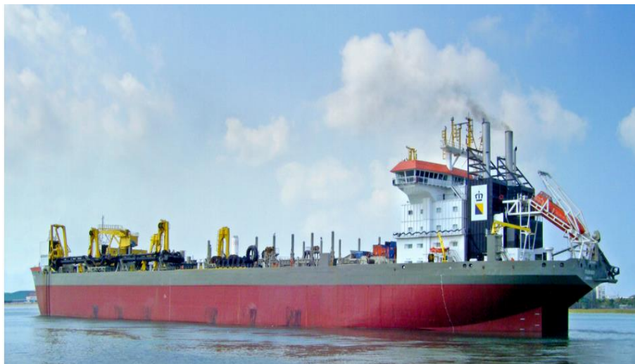
Figura 3. Dragas de succión de autopropulsión con tolva de succión a utilizar
