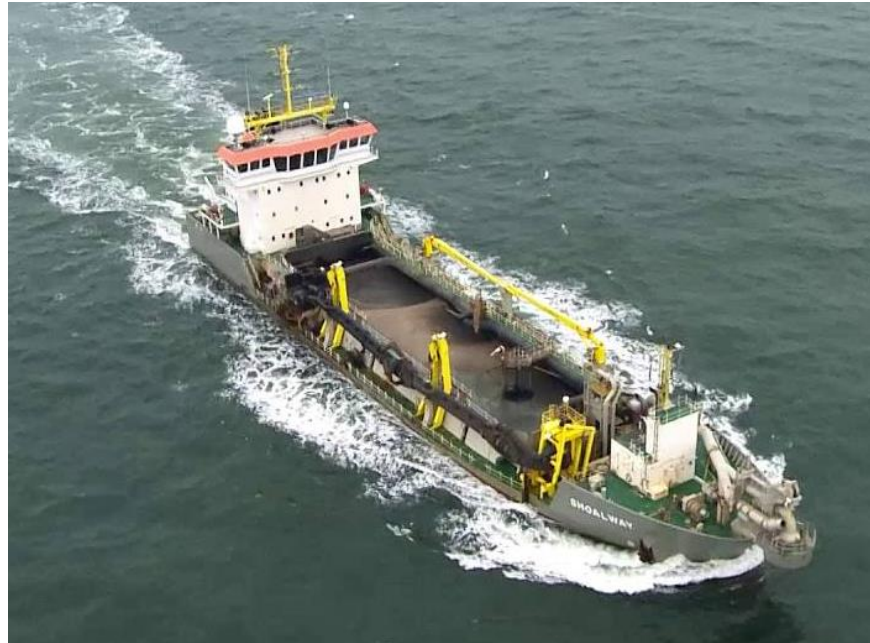
Figura 9. Tolva en draga de succión
