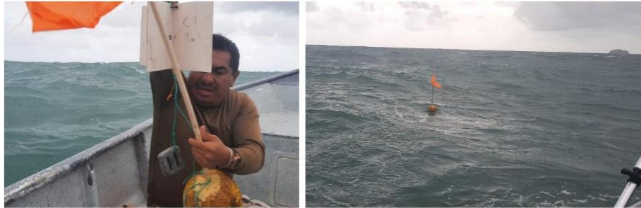
Foto 2 y 3. Colocación de derivadores para medir la corriente sitio, Los farallones, Costa Arriba Colon.
