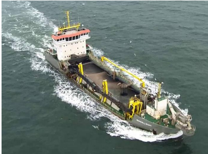
Figura 9. Tolva en draga de succión
