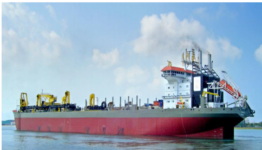
Figura 3. Draga de succión de autopropulsión con tolva de succión a utilizar
