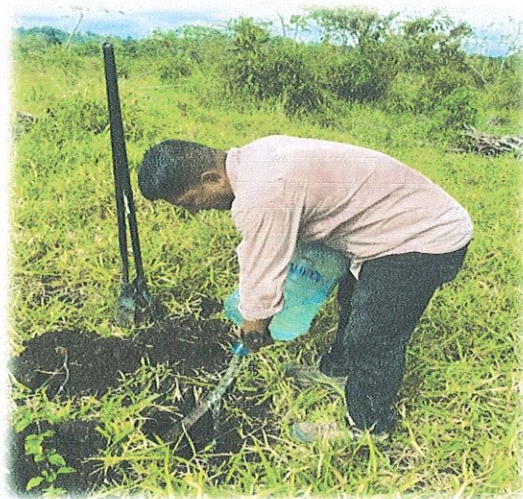
Foto 2: Vaciado del agua durante la prueba de percolación. 13 de Marzo 2,023
