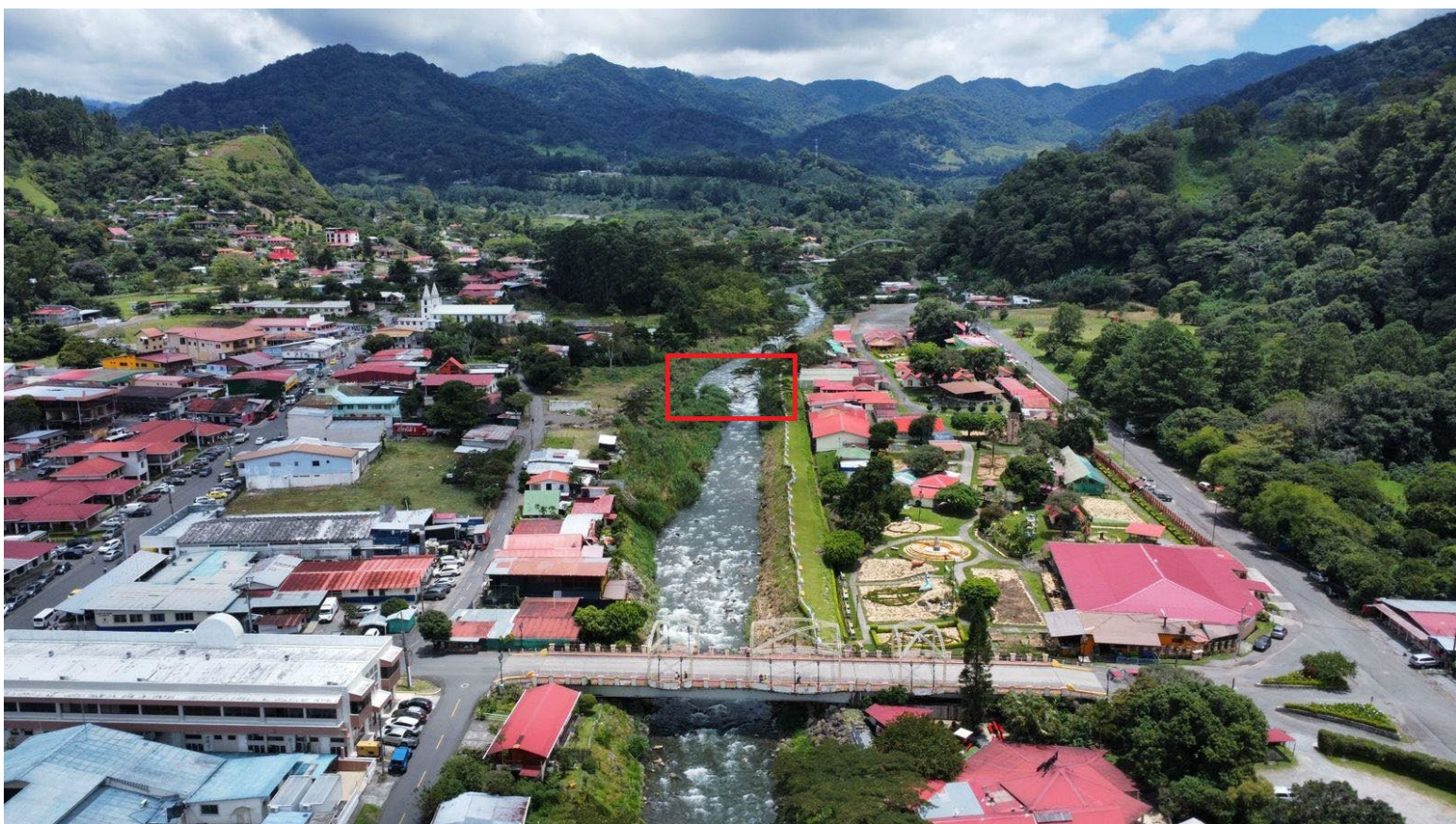
FIGURA A.2.3 El recuadro rojo muestra la zona donde se encuentra la sección crítica, hacia el sur se nota la ausencia de islotes y como el cauce se amplía lo que indica una reducción en el coeficiente de rugosidad de Manning n .
