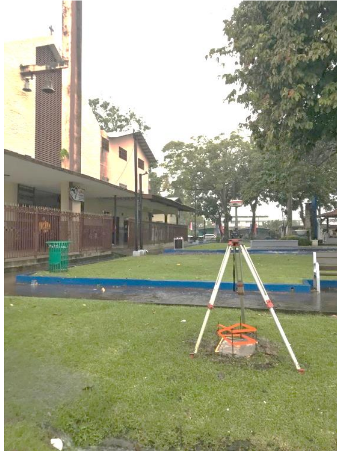
Figura N°6 Instalación y monumentación del punto de control PHP2
