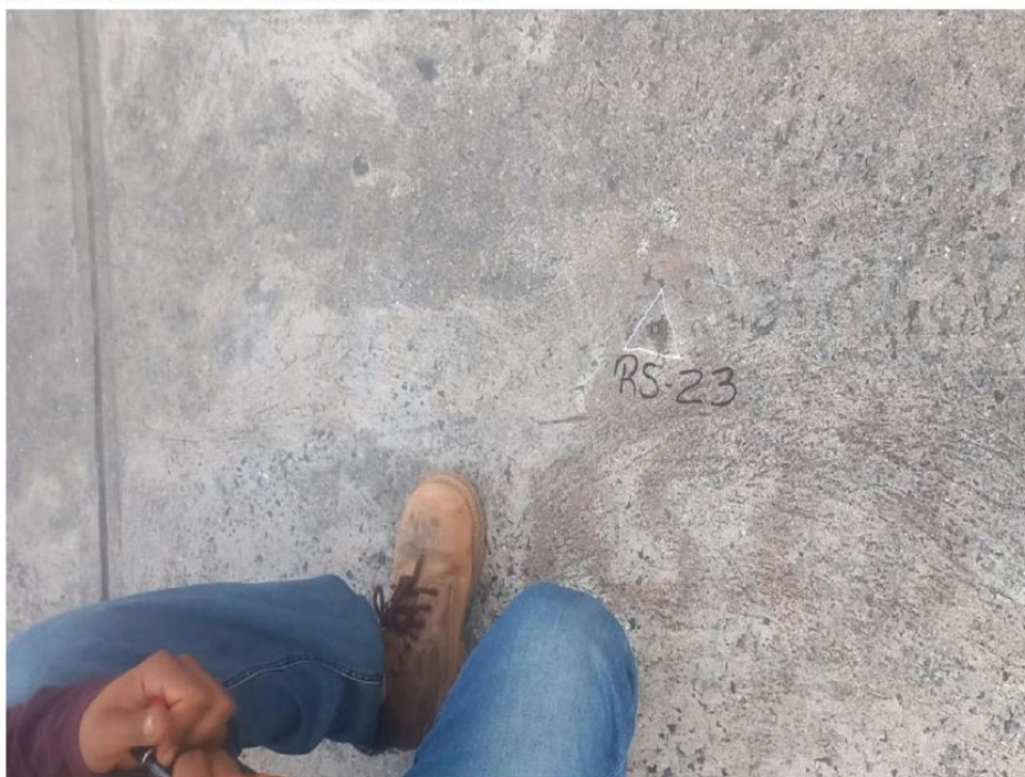
Vista de punto de control topográfico para línea base.
