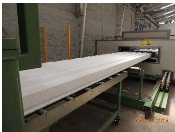
Figura 5.4 Lamias de Poliestireno Expandido Fabrica de SYNTHEON Chile (2015)
