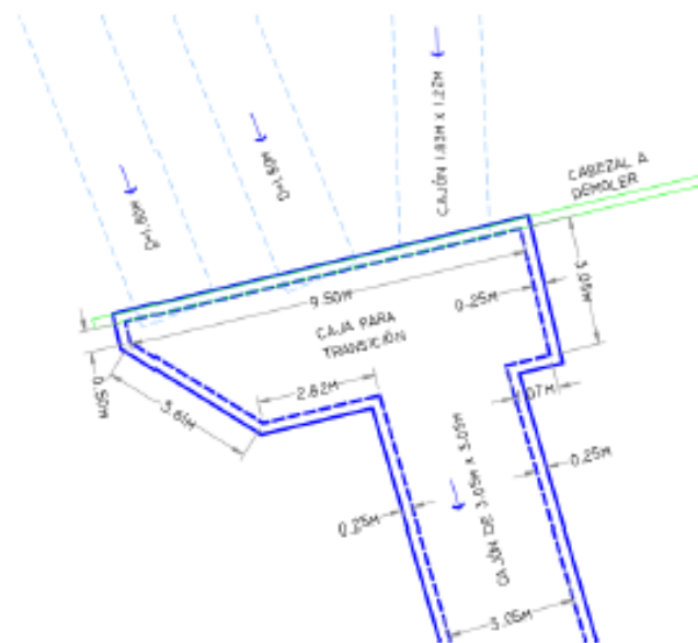
Figura 10: Detalle de la transición entre el cruce pluvial existente y el cajón proyectado
