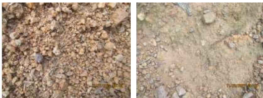
Imagen 4: Superficie de terreno de construcción de las galerías con suelo arcilloso color amarillo claro, con suelos del horizonte B debido a la extracción de material selecto.
