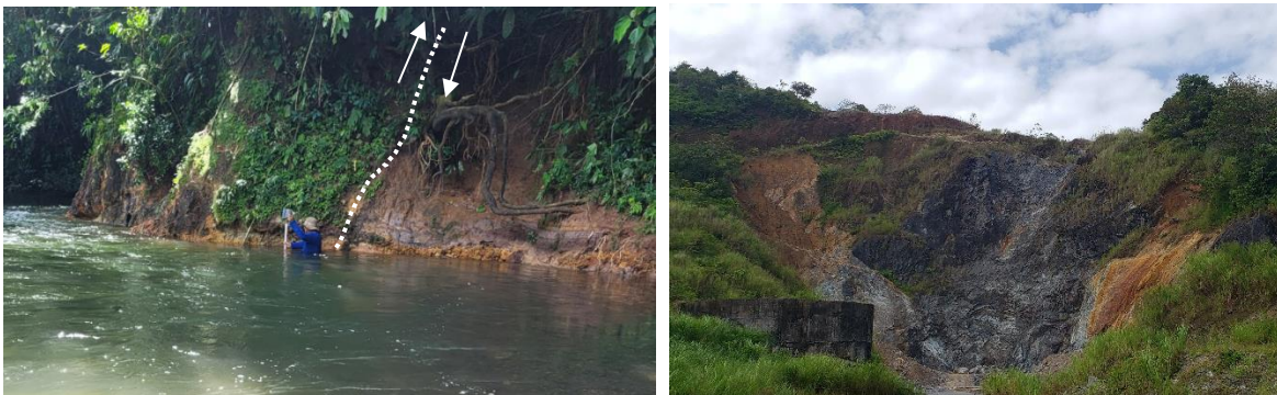
Figuras 13.- Contacto de falla entre basalto andesítico izquierda y dacítico derecha. Basalto dacítico en cara libre de la cantera María Chiquita.
