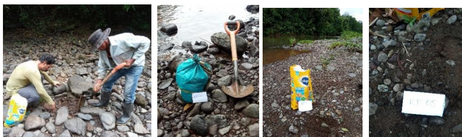
Figuras 16. Puntos de observación para toma de muestras de sedimentos, obsérvese el % de gravas y la matriz arenosa.
