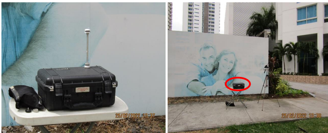
Imágenes 5 y 6. Vistas del equipo durante la medición de PM 10
