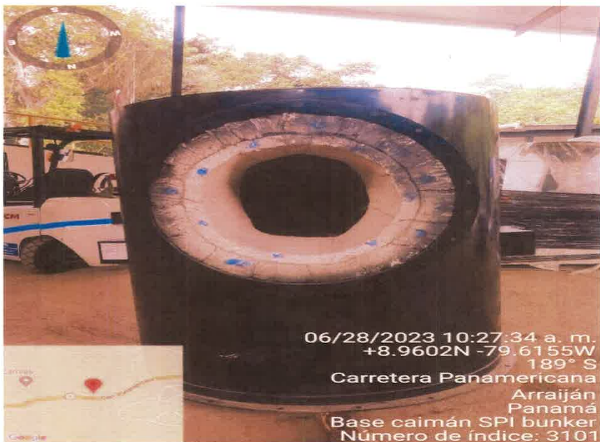
Segunda cámara de quemado de gases y filtro de lavado y precipitación
