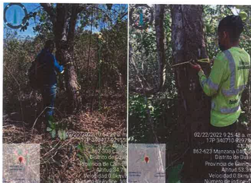
Figura No. 1. Corrección de la Figura No. 17. Medición de la circunferencia en centímetros de las especies forestales, base para el cálculo del DAP. Fuente: D. Aponte, 2022.
