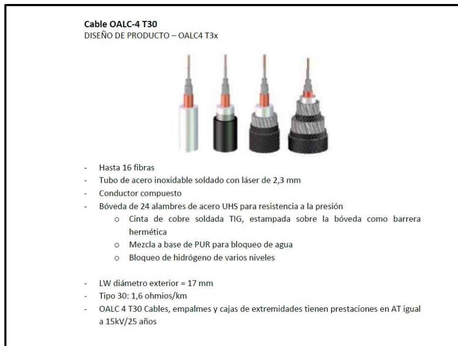
Ilustración 5-4. Especificación Técnica del Cable Soterrado
