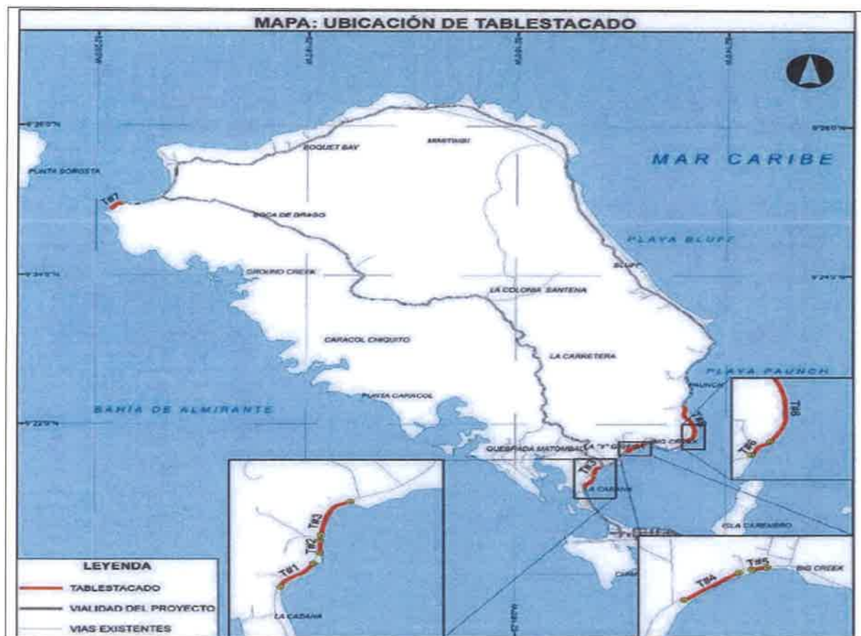
Imagen 3. Se observan los ocho puntos críticos de la vialidad que presentan erosión y se colocará tablestacado de PVC.
