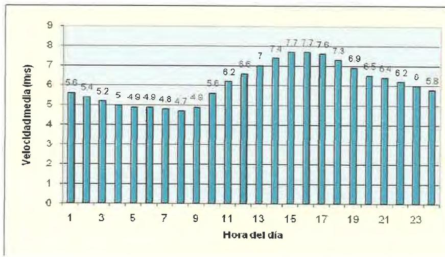
**Figura 5** Comportamiento diario de la velocidad de la estación Portobello (80 m).
