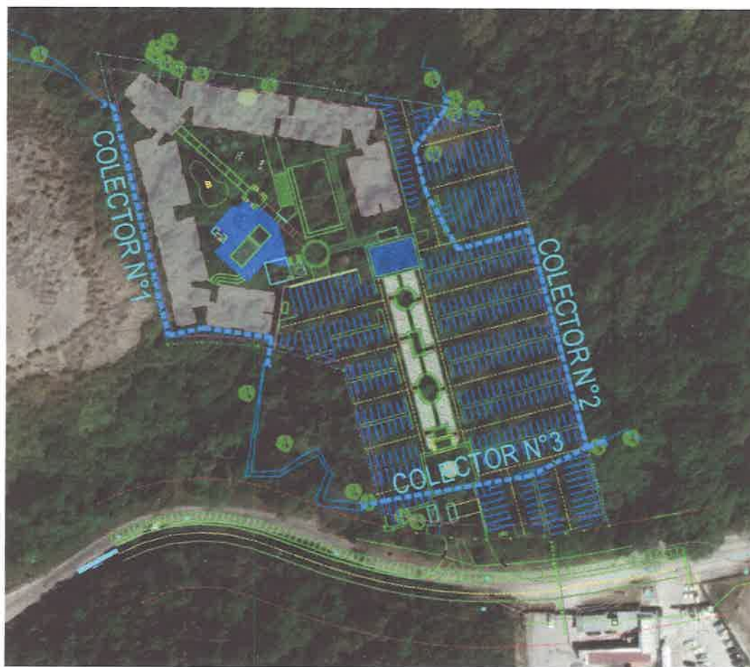
Ilustración 5: Colectores de Infraestructura Pluvial
