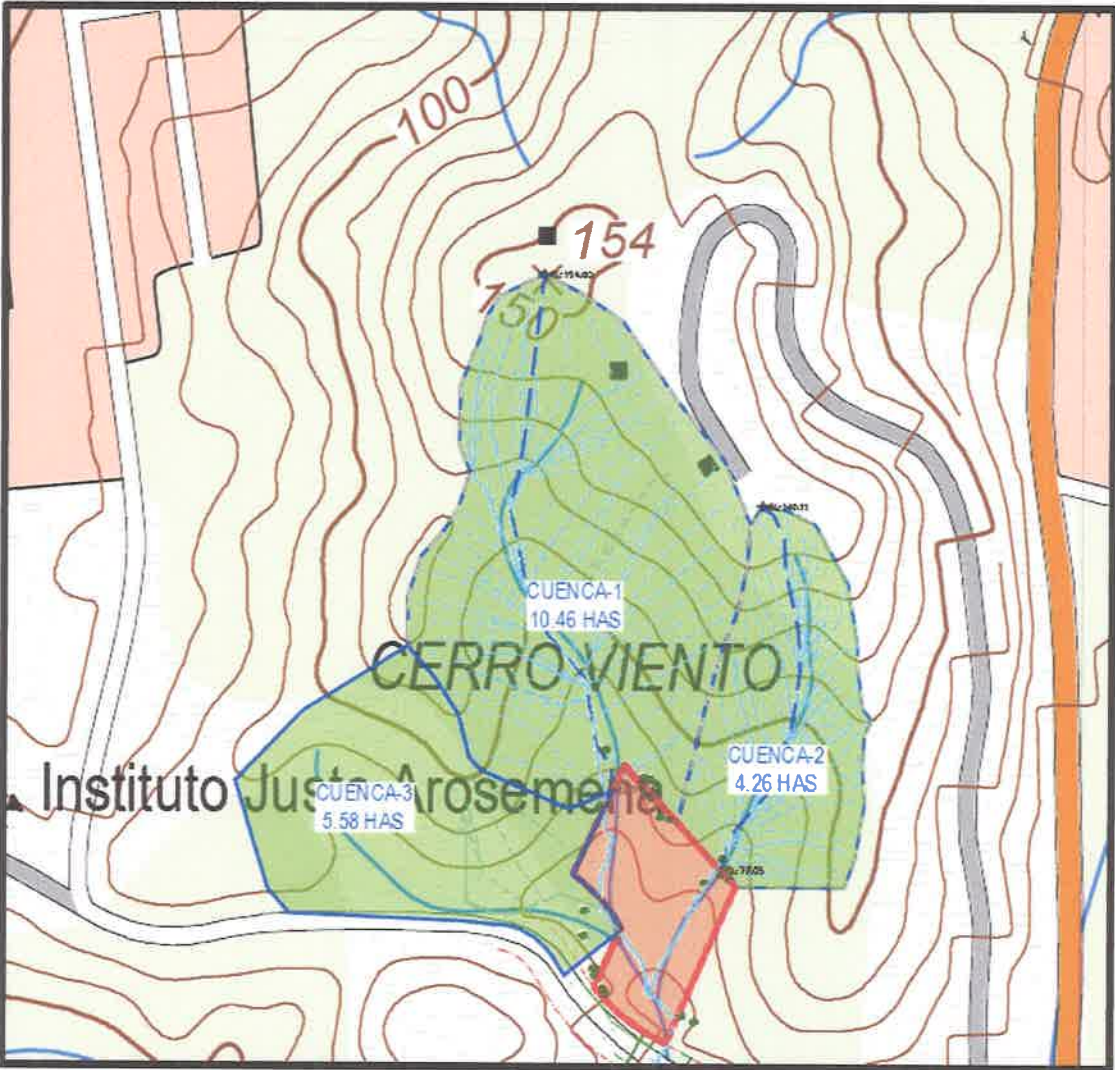
Ilustración 12: Áreas de Drenaje de las Diferentes Cuencas
