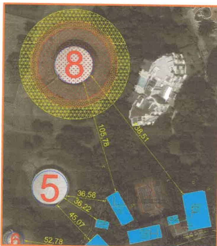
Figura 16. Grafica de afectación por radiación en simulación incendio tanque 8 hacia edificios
