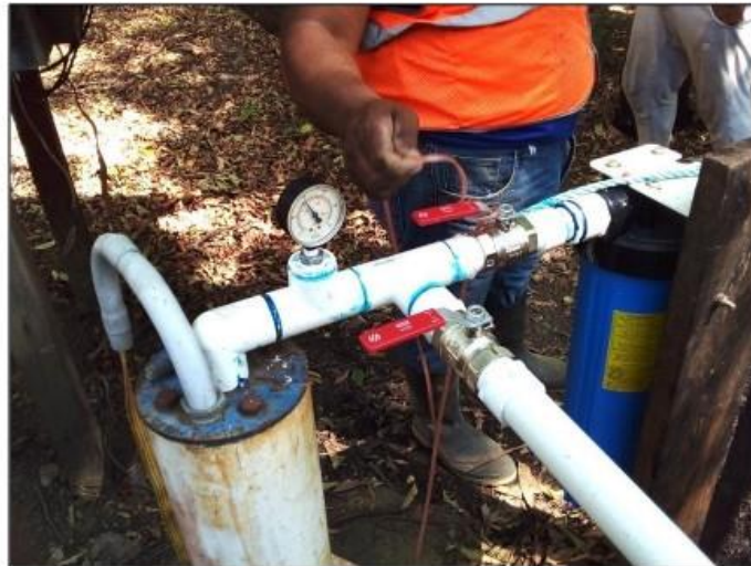
Figura 18. Detalle de plomería especial para realizar la prueba del Pozo 2-E, sin detener el suministro a los usuarios. Referencia de caudal por manómetro. Fuente: Equipo Consultor, 2023.
