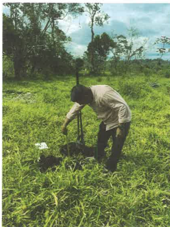
Foto 3: medición de descenso del agua en el hoyo 1. 13 de Marzo 2,023.
