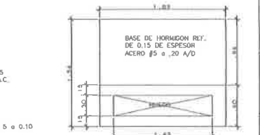
PLANTA DE BASE PARA SWITCHGEAR ESCALA 1:25
