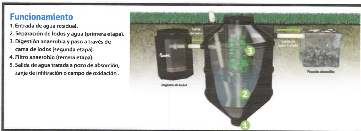
Imagen No.2: Funcionamiento del sistema sanitario (Biodigestor)
