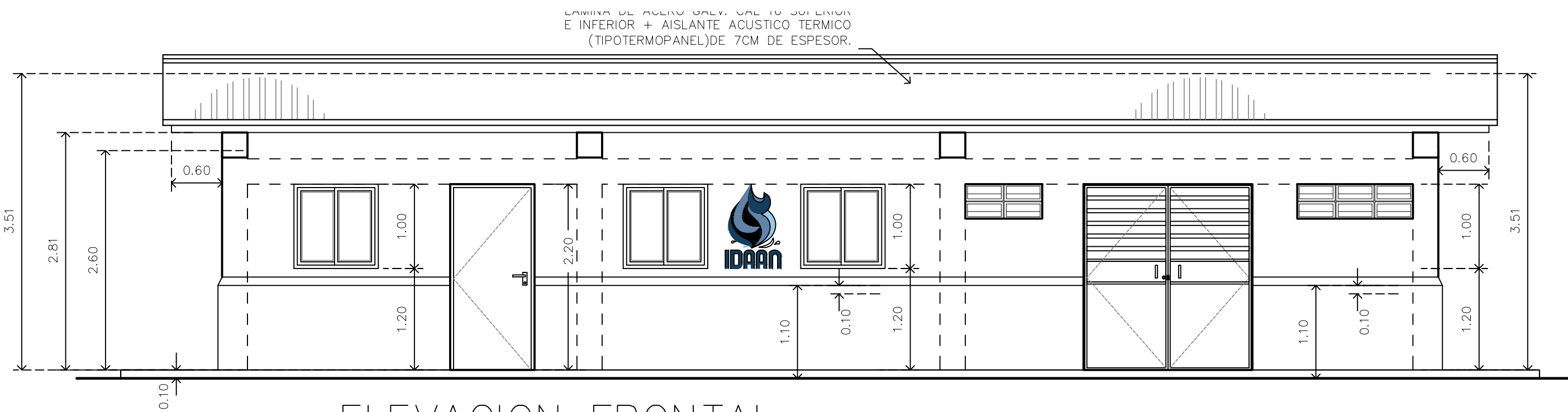
ELEVACION FRONTAL ESCALA 1:50 EDIFICIO ADMINISTRATIVO
