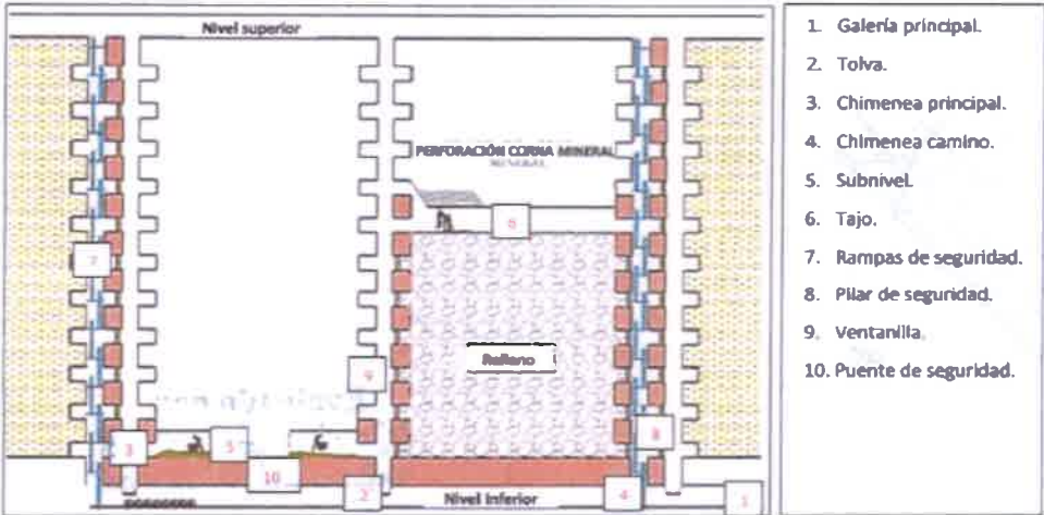
Figura 5.18. Esquema de Método de explotación por corte y relleno ascendente y estructuras que deben incluirse en la adecuación de las labores subterráneas.
