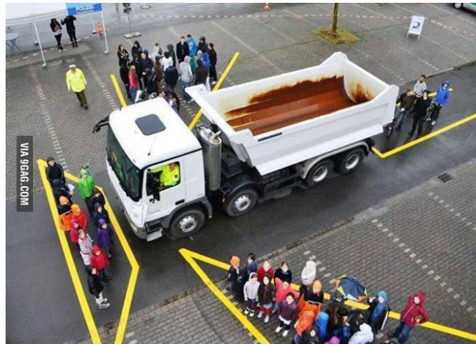
Fuente: archivo fotográfico del equipo consultor Figura 2: Puntos ciegos para el conductor de un camión
