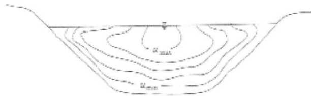
Figura 4. Distribuciones típicas de la velocidad en un canal abierto.
