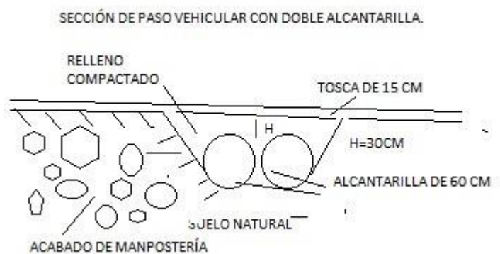
Ilustración No. 3. Sección de paso vehicular de alcantarilla
