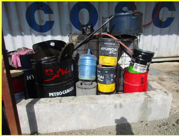
Fotografía 4 Recipientes con hidrocarburos (aceites, grasas, líquido hidráulico, etc.) con su tina de contención
